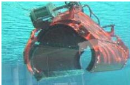
Vue du SFRS Pipeline dans les bassins de l'Ohmsett (Source : Windsor Innovations)
