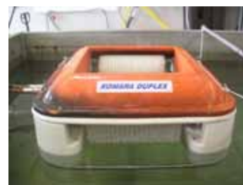
Le Komara Duplex testé en configuration brosses oléophiles (Source : Cedre)
