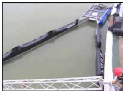
Système de récupération dynamique équipant les navires de service chinois (Source : Slickbar )
