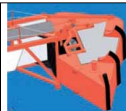
Base du sweeping arm équipé d'une grille de filtrage et d'un bac récupérateur breveté (Source : G2B)
