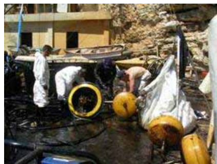
Récupérateur Foilex : démontage de la pompe bloquée par les macrodéchets (source : Cedre)
