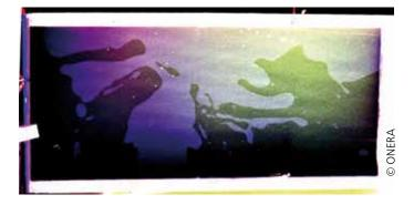
Images en fausses couleurs d'une nappe d'huile de colza (en haut) et de toluène vue par la caméra hyperspectrale Hyspex dans le domaine réflectif. Le cadre de piégeage est en blanc sur les images et le produit est déversé à l'intérieur sur la surface
