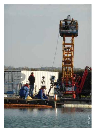
Configuration horizontale - Déversement de méthanol en premier plan, capteurs optiques hyperspectraux en second plan
