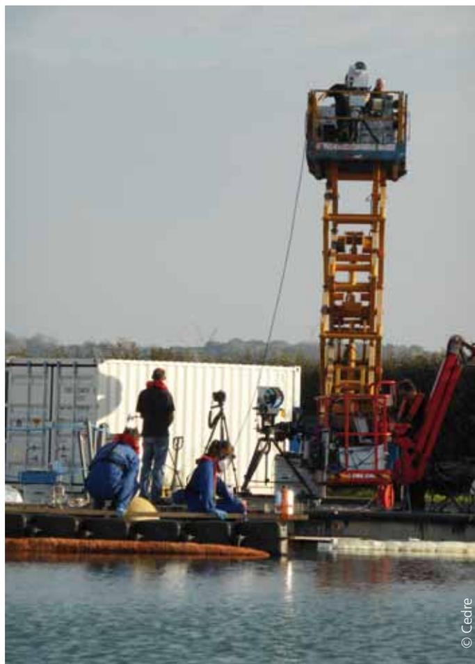
Configuration horizontale - Déversement de méthanol en premier plan, capteurs optiques hyperspectraux en second plan
