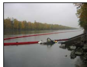
L' Hydrodynamic Circus , le Foilex et la Depa b) en préparation ; d) En fond de poche de confinement (source Lefloch Dépollution )
