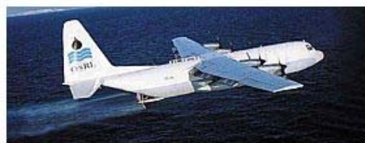
Le système Nimbus-Hercules en cours d'épandage. (source Ayles Fernie)
