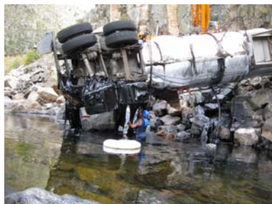
Relèvement de la citerne : un intervenant en détache le bitume solidifié à l'aide d'une hache (source : EPA)
