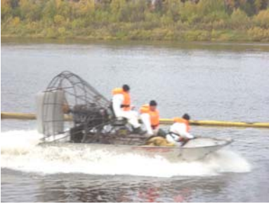
Déploiement de barrages par hydroglisseurs ( gauche ) ou petits catamarans ( centre ), et mobilisation d'une vedette pour le transport de personnels et de matériels –barrages, groupes hydrauliques, récupérateurs, lances, etc. ( droite ) (Source : Cedre)
