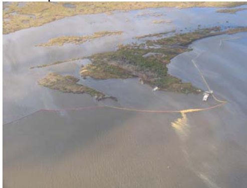
Remobilisation du brut échoué : irisations et échappement du produit (traînées jaunâtres) en fond de dispositif de confinement (Source : NOAA)
