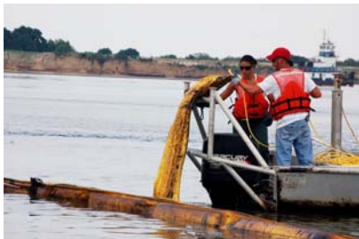
Déploiement de barrages flottants (Source : USCG)
