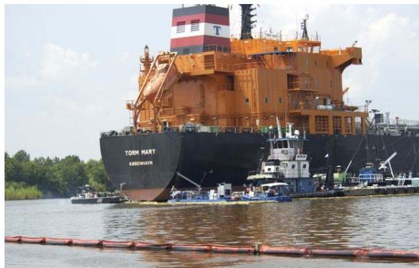
Confinements successifs de la pollution par barrage absorbant puis barrage barrière autour du navire, récupération des hydrocarbures par une barge équipée d'un récupérateur à bande transporteuse (source : USCG)
