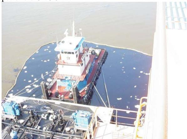
Confinement par barrage absorbant d'une partie des hydrocarbures autour du navire (source USCG)
