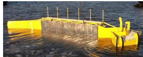
Bras rigide de 12 m + pompe (source : Hebo Maritiemservice )
