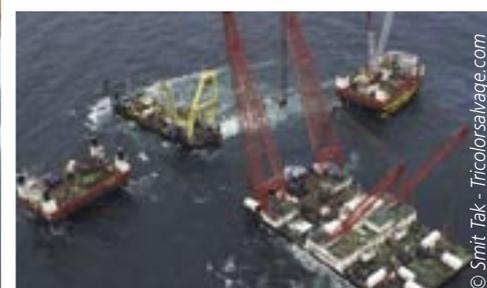
Le dispositif au complet, plate-forme de découpage et barges de relevage
