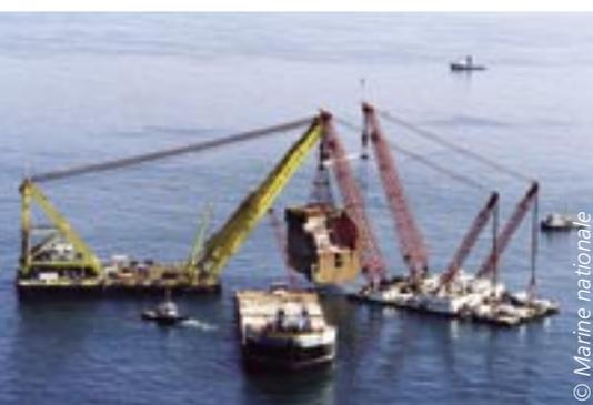
Chantier du *Tricolor* - relevage d'une section
