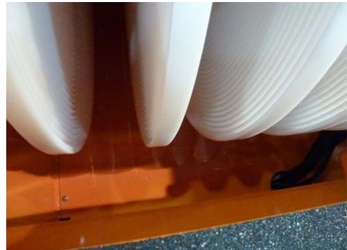
Vue de détail de la surface cannelée des disques oléophiles du récupérateur *Elastec X150* (Source : *Cedre*)
