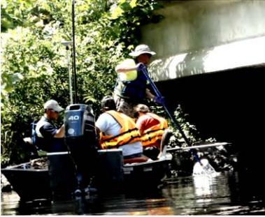
Opérations de « sondages » (poling) géoréférencés pour localisation/cartographie des dépôts submergés (Source : US EPA)
