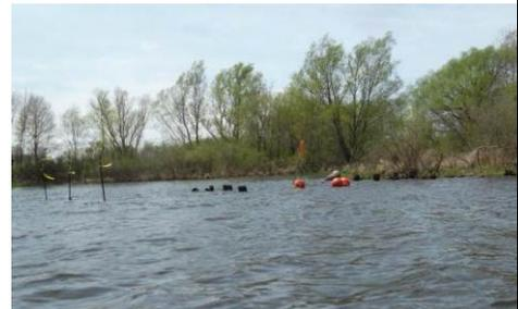
Pièges à sédiments (*sediment traps*), dûment signalés par bouées dans un secteur sélectionné de la Kalamazoo River
