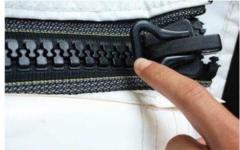
Vue du système de connexion de type « S140 » (Zip Marine Industriel) (Source : [www.eurofilet.fr/](http://www.eurofilet.fr/))
