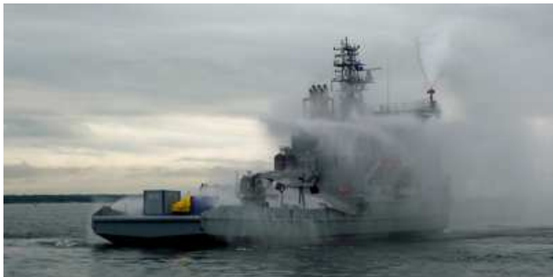
Le Louhi, supply finlandais. Ce navire multifonctions de 2011 est spécialisé dans l'intervention sur pollution chimique et par hydrocarbures. Ici activation des jets pour intervention sur pollution chimique et nuage gazeux © Cedre
