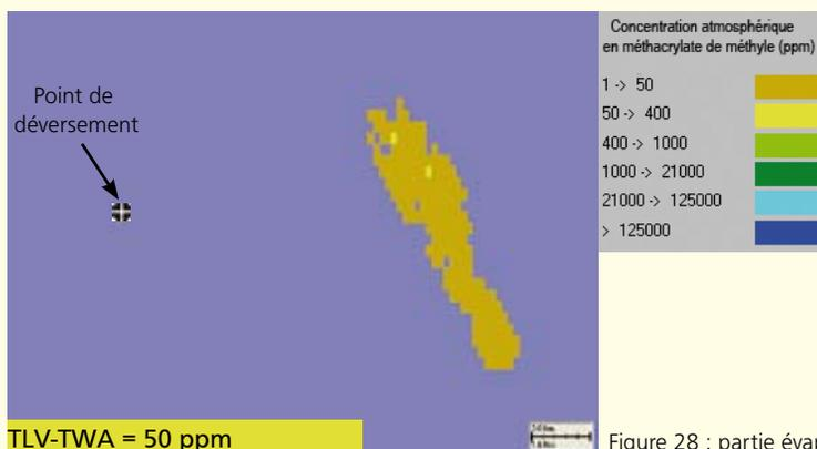
Figure 28 : partie évaporée en plan, vent de 3 m/s NW
