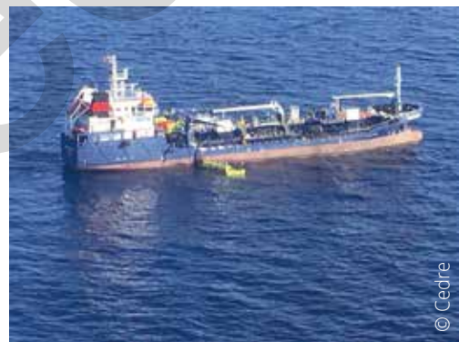
Récupération par sweeping arms , (collision Ulysse/CSL Virginia, 2018)
