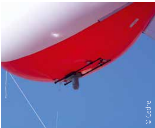
Capteur placé sous un ballon captif
