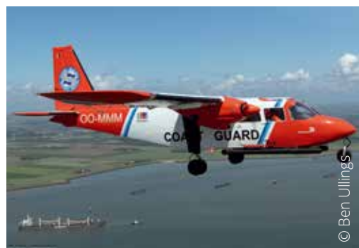
Avion de mesure des émissions de gaz mis en œuvre par le Royal Belgian Institute of Natural Sciences
