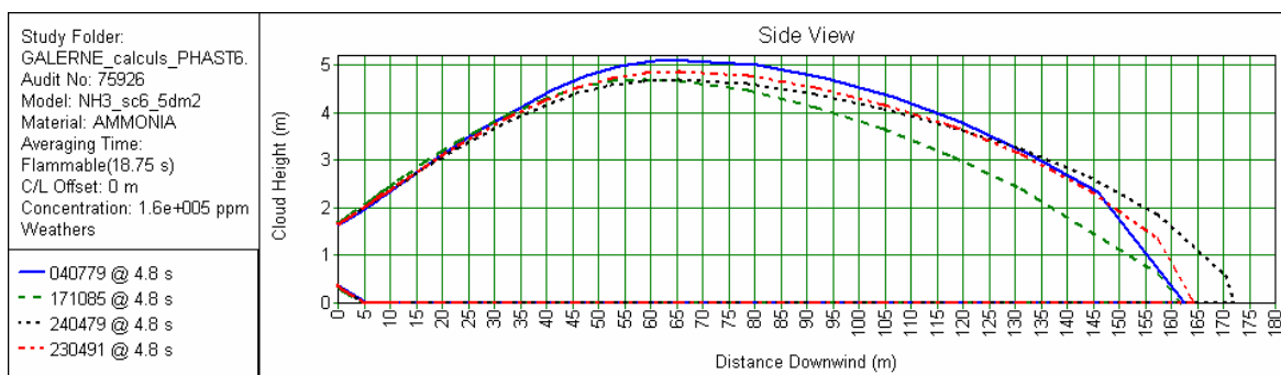
Figure 23. Vue latérale du nuage inflammable d'ammoniac pour une fuite au travers d'une brèche de 5 dm 2 dans les quatre situations atmosphériques retenues.
