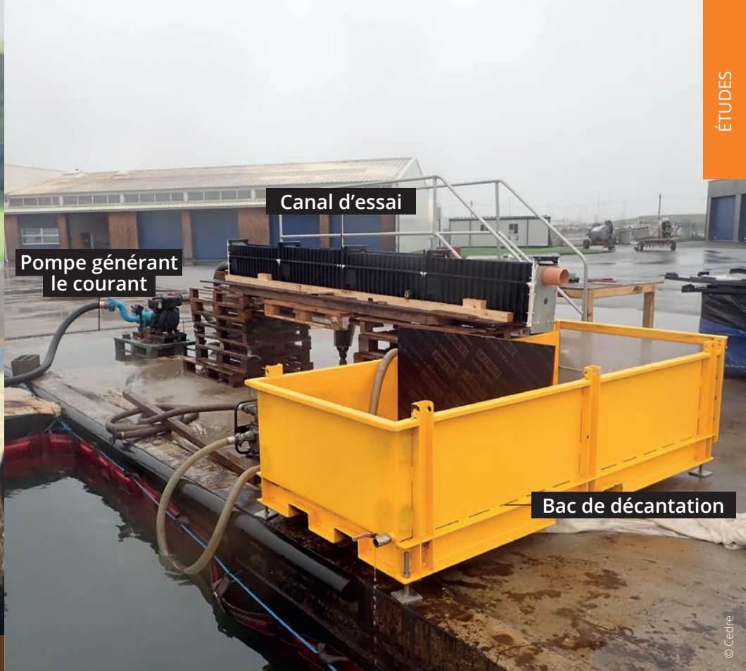
▲ Installation du dispositif de test de filtration
