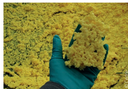
▲ Croûte de soufre après déversement de soufre fondu dans le bassin profond du Cedre
