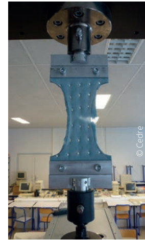
△ Éprouvette d'absorbant sur le banc de traction
