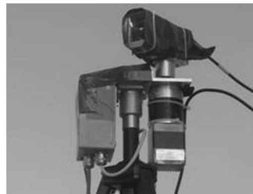
DEPOL 07 : la caméra infrarouge thermique du projet DETHERPOLMAR – Source Cedre
